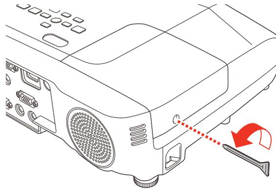
**Avertissement:** Si la lampe est cassée, le logement de la lampe peut contenir des éclats de verre. Soyez prudent en enlevant le verre cassé afin d'éviter des blessures. Si le projecteur est installé au plafond, placez-vous à côté du couvercle de la lampe et non pas sous ce dernier; des morceaux de verre pourraient tomber dans vos yeux ou votre bouche lorsque vous ouvrez le couvercle de la lampe.
