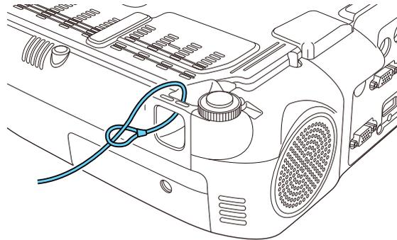
**Remarque:** N'attachez pas le câble antivol au point d'attache de câble antivol si vous installez le projecteur sur un mur ou au plafond.
