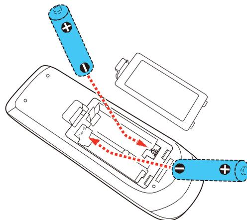
3. Remplacez le couvercle du logement des piles et appuyez dessus pour l'enclencher.
