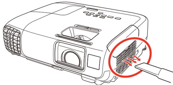
**Remarque:** Vous pouvez retirer le filtre à air afin de nettoyer ses deux côtés. Ne rincez pas le filtre à air dans l'eau et n'utilisez pas un détergent ou un solvant pour le nettoyer.
