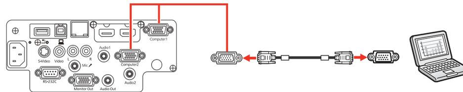
4. Serrez les vis du connecteur VGA.
