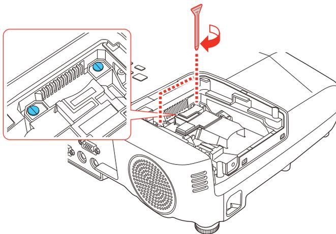
**Mise en garde:** Ne serrez pas trop les vis.
