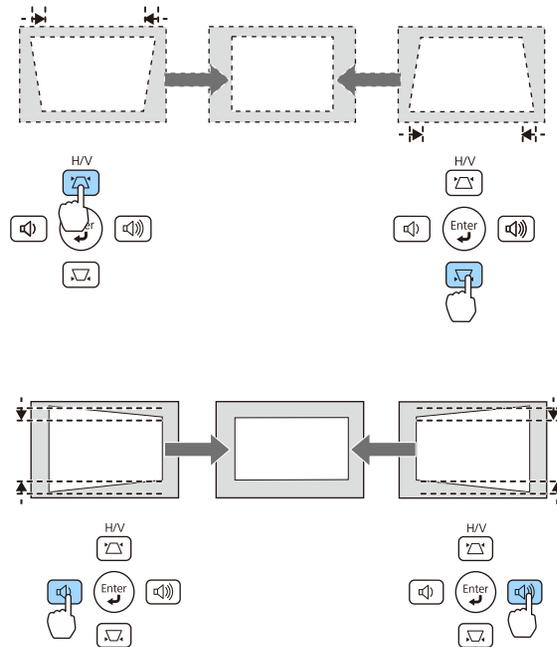
**Remarque:** Les touches de correction trapézoïdale horizontale sont étiquetées **Wide** et **Tele** sur le projecteur PowerLite S27.
