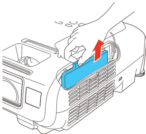
**Remarque:** Les filtres à air contiennent de la résine ABS et de la mousse de polyuréthane. Éliminez les filtres usés conformément à la réglementation locale.
