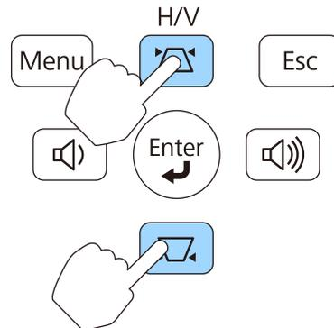
3. Appuyez sur une touche de correction trapézoïdale sur le panneau de commande du projecteur pour régler la forme de l'image.
