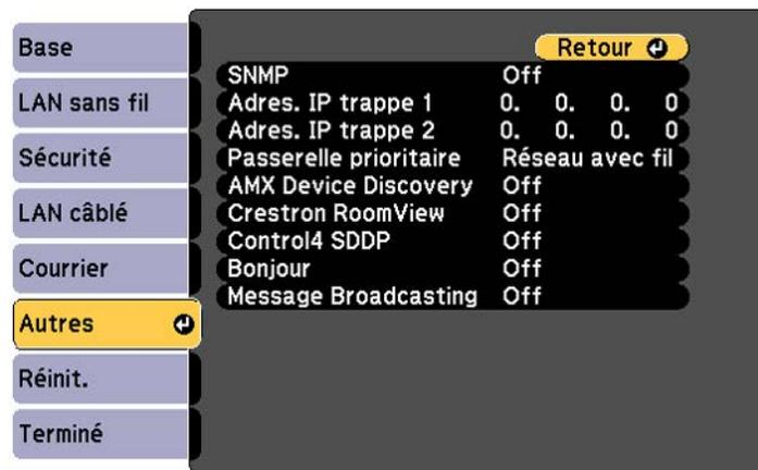
5. Réglez le paramètre **Crestron RoomView** à **On** afin de permettre au projecteur d'être détecté.
