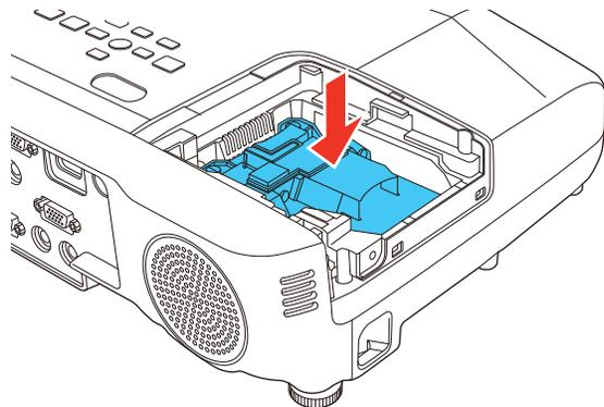
**Mise en garde:** Ne touchez à aucune partie en verre de la lampe afin d'éviter sa défaillance prématurée.
