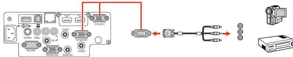
3. Serrez les vis du connecteur VGA.
