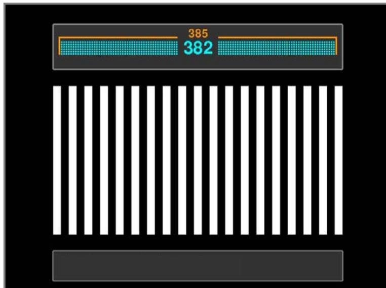
2. Faites tourner la bague de mise au point jusqu'à ce que le chiffre en vert soit presque équivalent au chiffre en orange.
