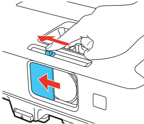
2. Pour recouvrir l'objectif ou provisoirement couper l'image et le son, fermez le couvre-objectif en glissant la coulisse **A/V Mute**.
