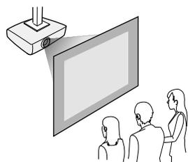
Peu importe où vous installez le projecteur, veillez, dans la mesure du possible, à le placer perpendiculairement en avant du centre de l'écran et non pas de biais.
