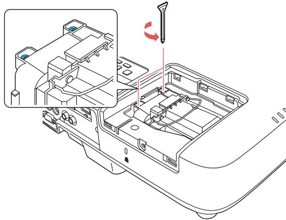
9. Remettez le couvercle en place et serrez la vis pour le fixer.
