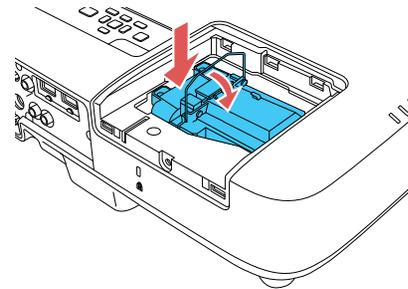
**Mise en garde:** Ne touchez à aucune partie en verre de la lampe afin d'éviter sa défaillance prématurée.
