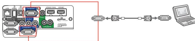
4. Serrez les vis du connecteur VGA.
