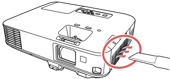
**Remarque:** Vous pouvez retirer le filtre à air afin de nettoyer ses deux côtés. Ne rincez pas le filtre à air dans l'eau et n'utilisez pas un détergent ou un solvant pour le nettoyer.
