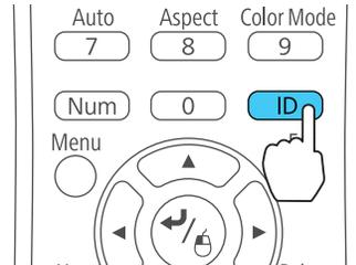
5. Appuyez sur la touche **ID** de la télécommande pour vérifier si la définition de l'identificateur a fonctionné.
