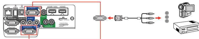
3. Serrez les vis du connecteur VGA.
